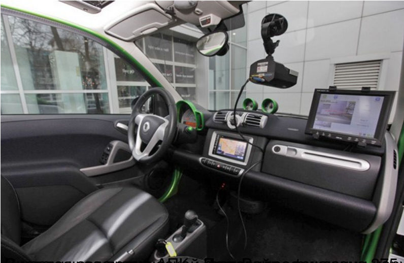
Видеосъемка с помощью комплексов фотовидеофиксации нарушений ПДД в автомобиле разворачивается (в уменьшенном виде)
